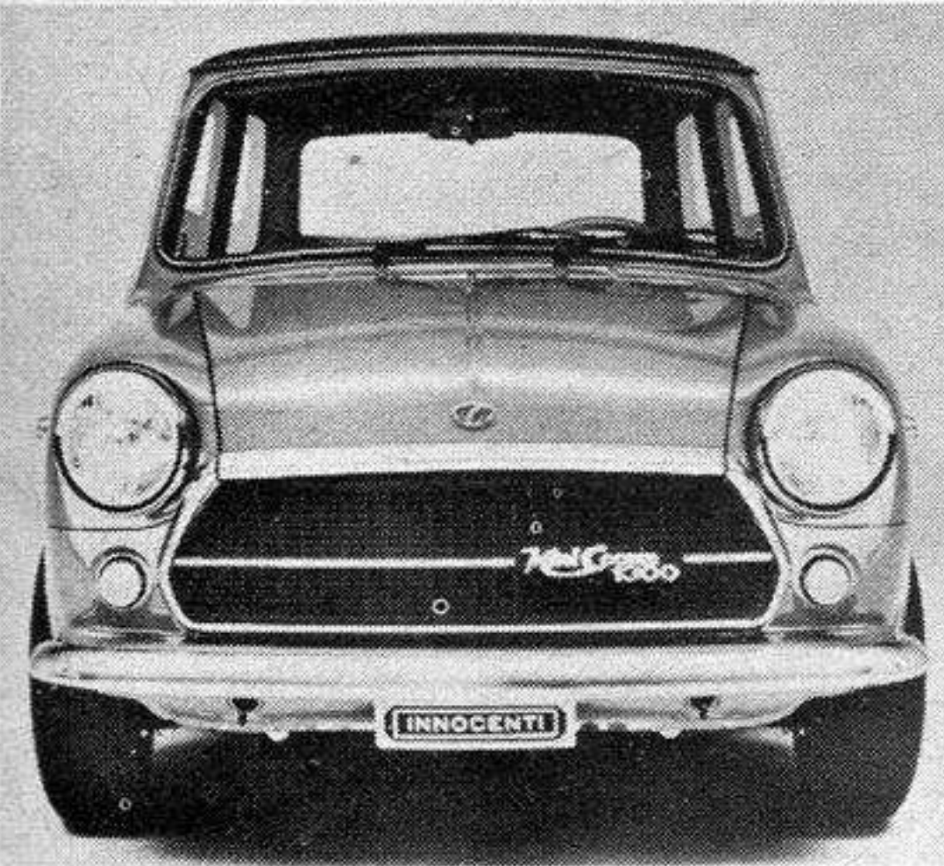
B.L. INNOCENTI - MINI COOPER 4 cilindri in linea / 1275 cmc 71 CV a 5800 giri / 160 kmh
