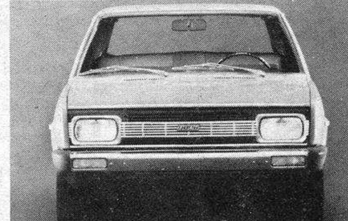
SIMCA 1100 ti 4 cilindri in linea - 944 cc 82 CV a 6000 giri - 165 kmh
