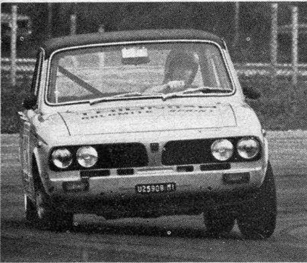
TRIUMPH DOLOMITE S 4 cilindri in linea / 1998 cmc 135 CV a 6000 giri / 195 kmh
