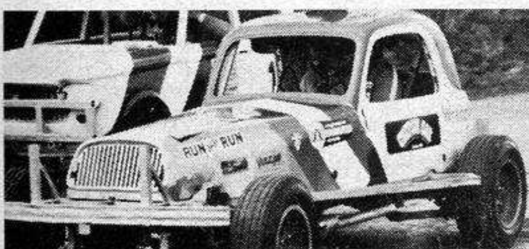
SUPER STOCK 4 cilindri in linea 1600 cc 110 CV
