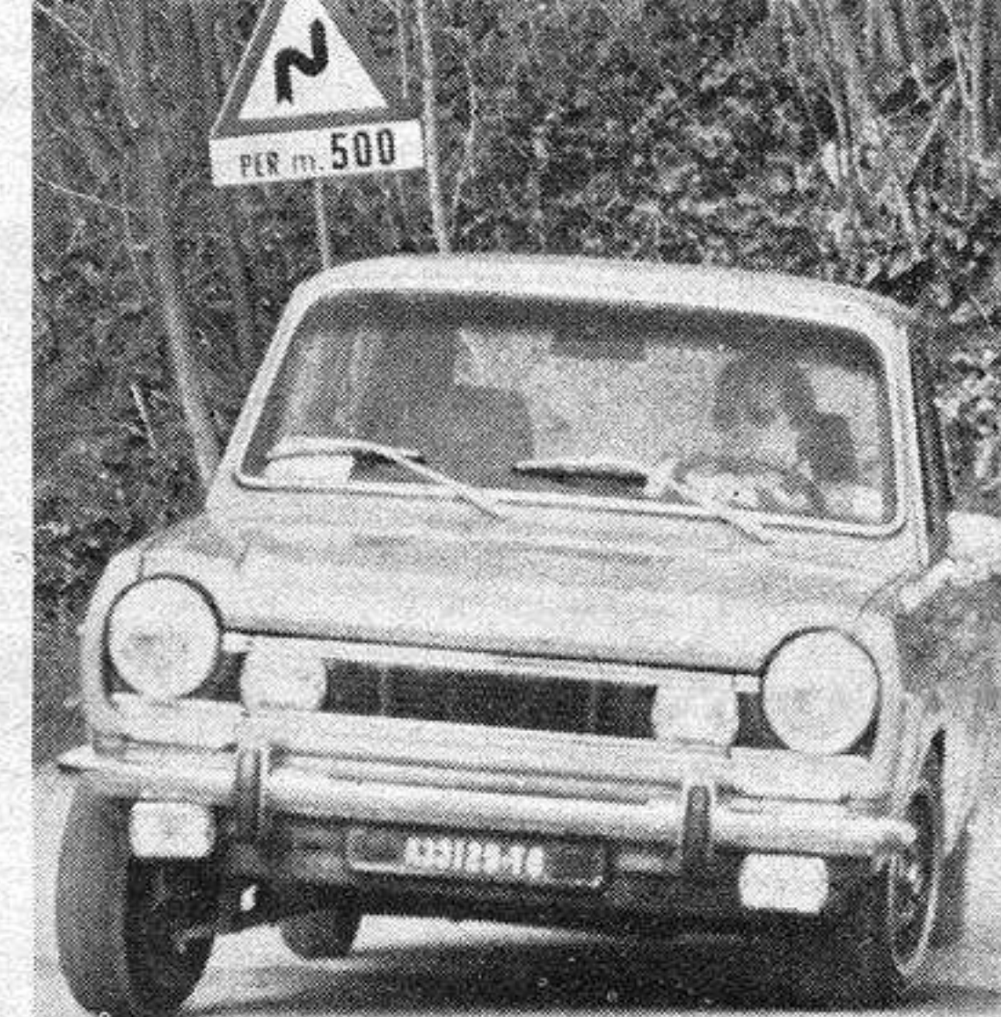
SIMCA 1100 ti 4 cilindri in linea - 944 cc 82 CV a 6000 giri - 165 kmh
