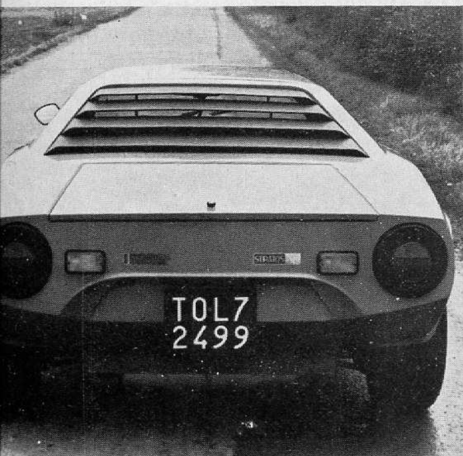
La parte posteriore della Stratos, con le « palpebre » al lunotto in funzione antiabbagliante
