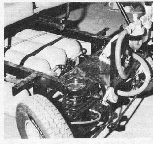
Qui sopra ed a destra, tre viste dell'interessante vettura (per ora c'è l'autotelaio) di Sorgato, funzionante con l'aria compressa contenuta nelle bombole ben visibili. A destra in alto vediamo anche il comando del «gas»
