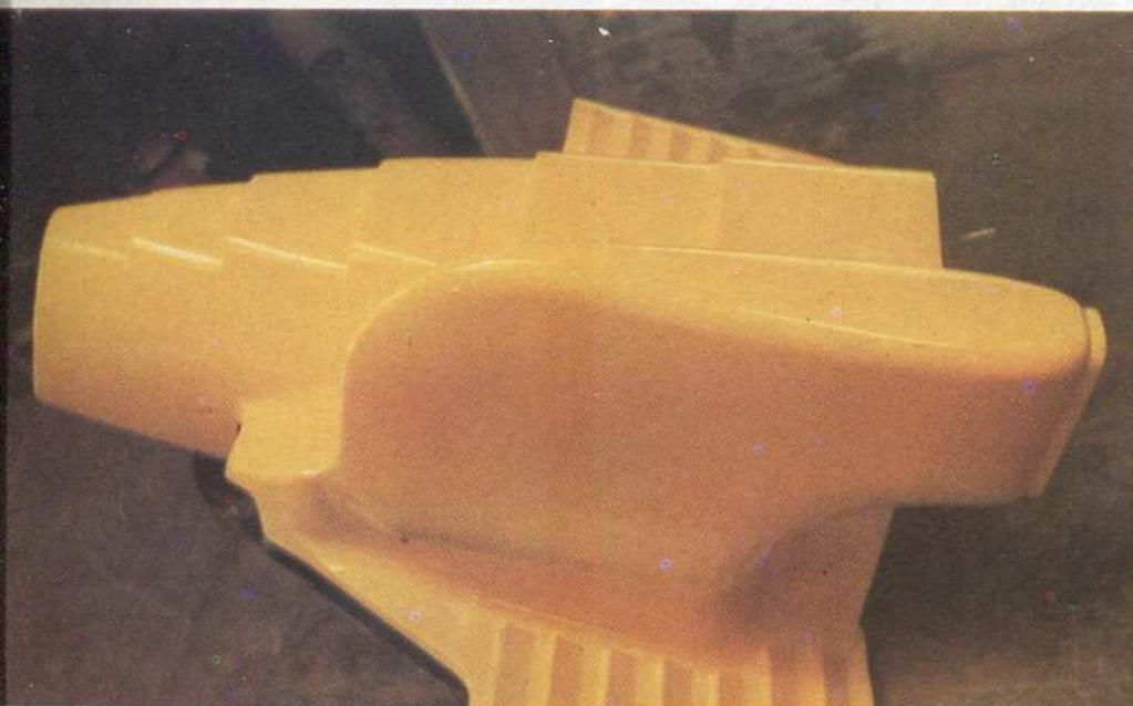
Altre immagini all'interno della March. A sinistra, un 753-Toyota in ultimazione. Sotto, da sinistra, la bellissima linea della nuova F. 3 e la sua sezione di coda, con il radiatore acqua nel lato sinistro. Inoltre il retrotreno di una F. Atlantic. Qui sopra, blocco unico per carenatura e aircscoop
