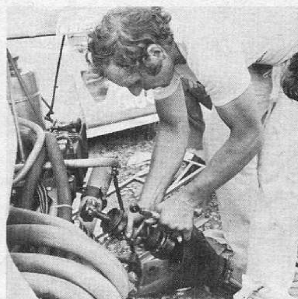
Nell'intervallo tra le due prove, meccanico di lusso per Truffo: Brambilla sostituisce il manicotto scorrevole sulla March. A sinistra dalle tribune, ora provvisorie, si ha una veduta molto spettacolare del nuovo autodromo del Mugello
