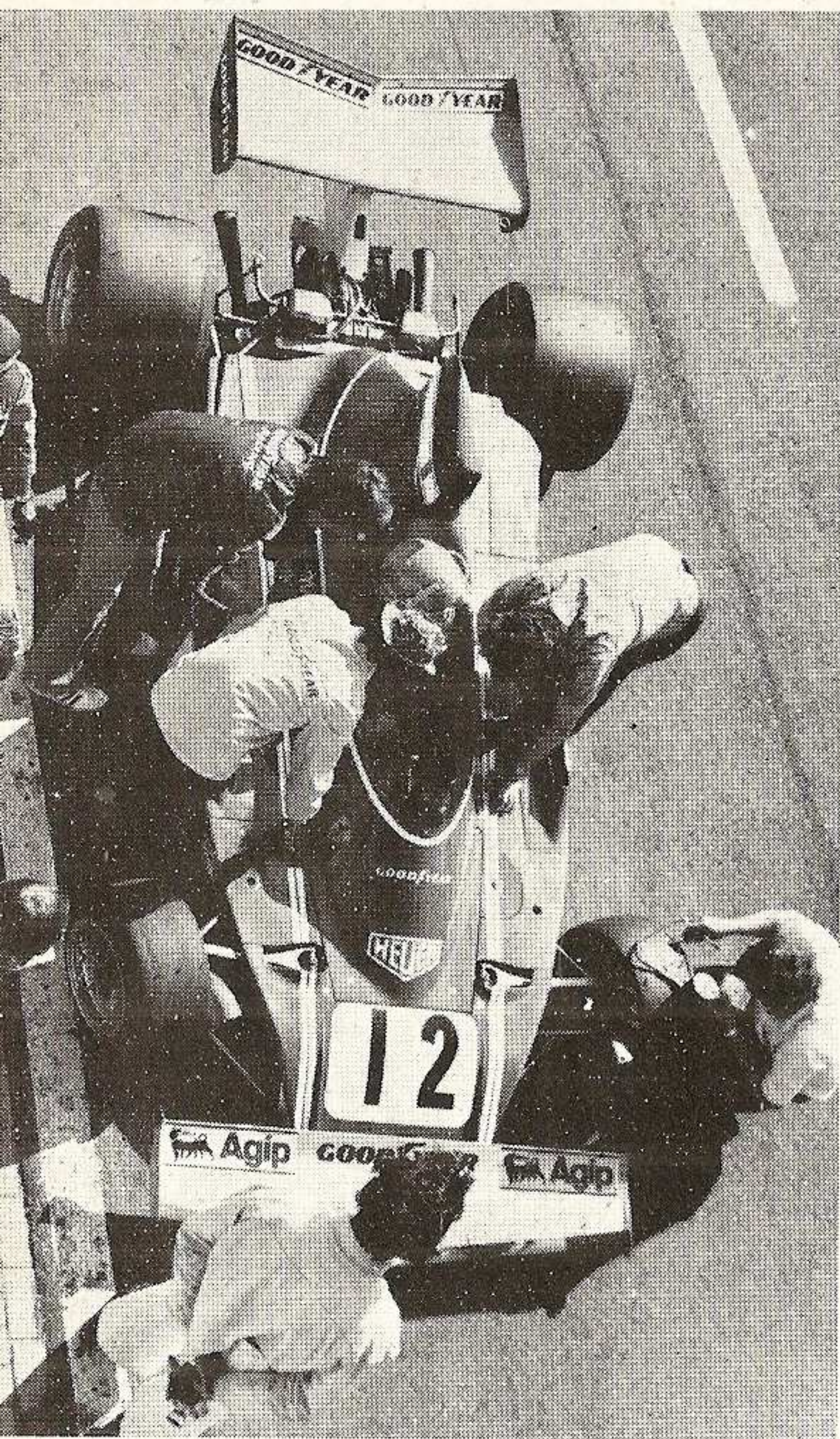
Novità sull'alettone della Ferrari: la nuova forma a V, somigliante a quella degli aerei, garantisce una maggiore aderenza della vettura
