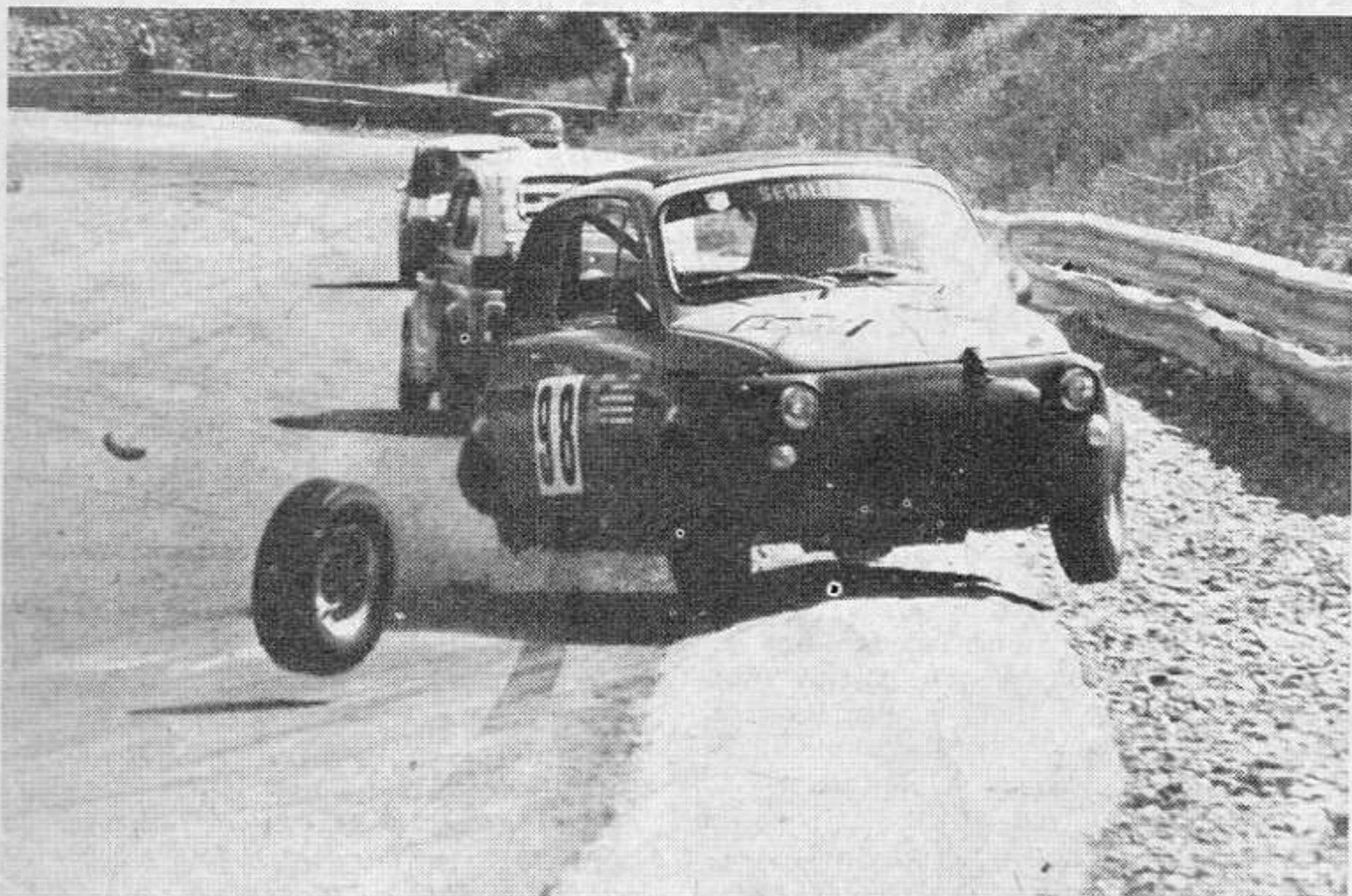
La rottura del mozzo della ruota posteriore destra della sua 500 ha giocato un brutto scherzo a Giancarlo Segalini, nel corso della gara per le minime cilindrata a Varano. Ecco la vettura piroettare alla curva della « Ickx »
