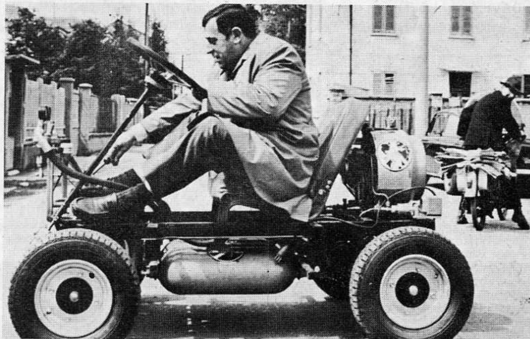
La crisi energetica ha aguzzato l'ingegno del signor Vittorio Sorgato, che in sei mesi ha progettato ed assemblato questo veicolo con propulsione ad aria compressa. Ha un'autonomia di circa 70 chilometri e pare possa raggiungere agevolmente una velocità di 70 kmh
