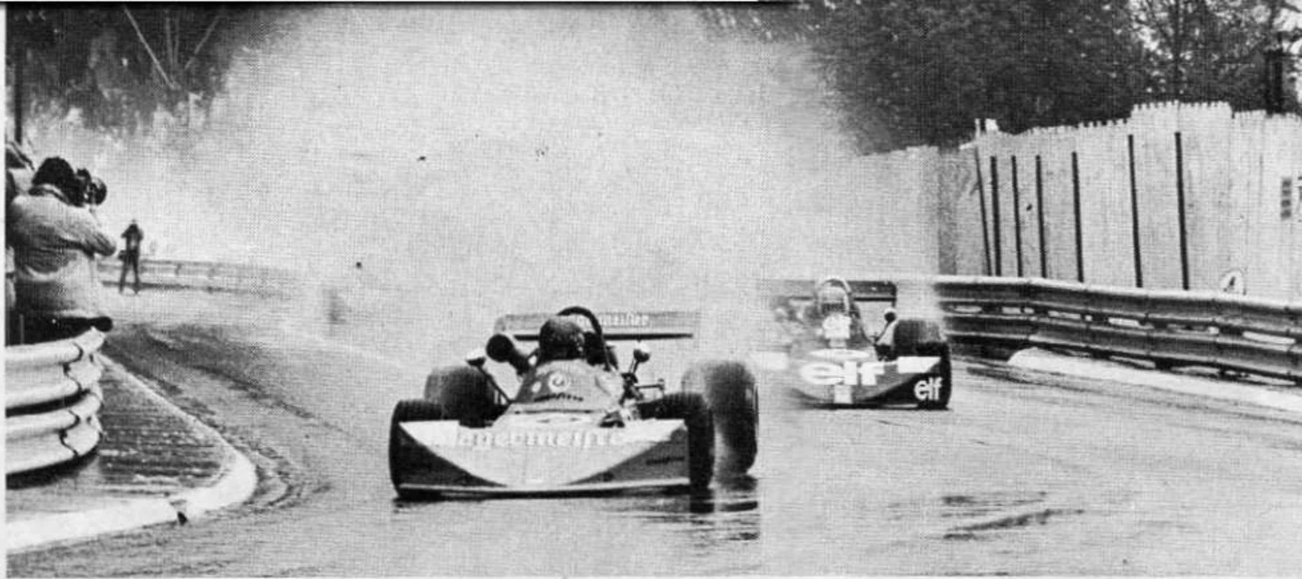
Le March 742 ufficiali continuano a « ritoccare » il loro muso. Ora, dopo l'avanzamento già notato a Barcellona, hanno un « labbro » e 2 alette in più
