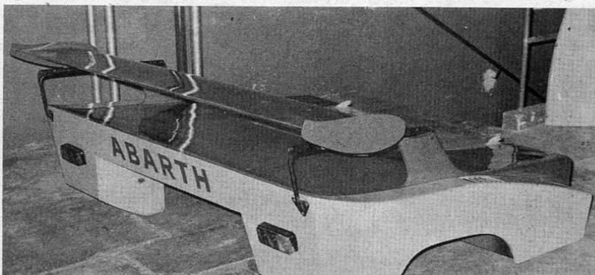
Qui sopra, una vista globale del telaio. Si nota la monoscocca centrale ed il telaio in tubi posteriore. In evidenza la flangia molto abbondante prima del cambio ed il radiatore acqua, unico, montato sul lato destro. Sotto, la nuova sezione di coda sperimentale che presenta un traliccio in grado di posizionare a piacimento l'alettone
