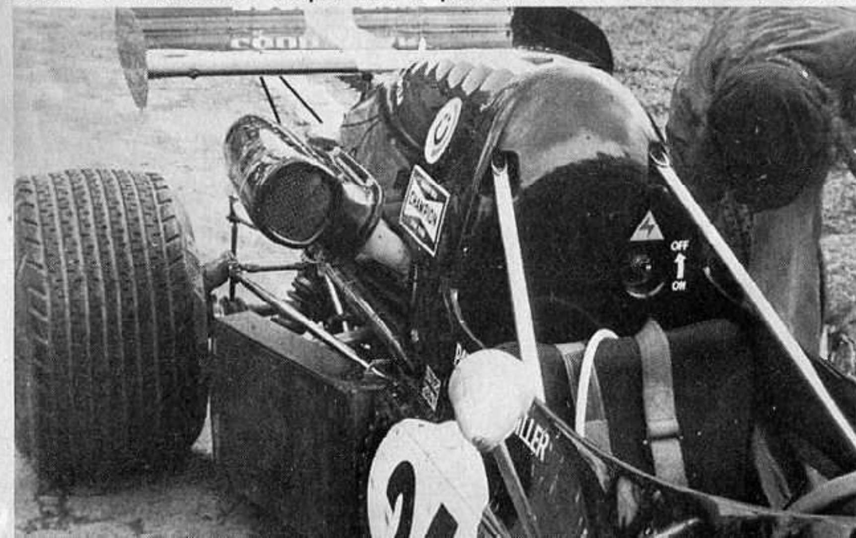
Sotto, un dettaglio della recentissima versione della March 742 « ufficiale ». Il radiatore acqua non è più sul muso, ma sul lato destro
