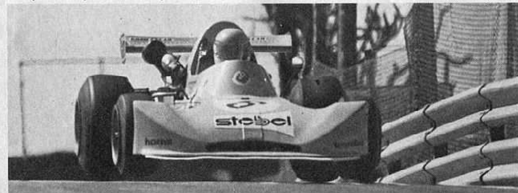
Sotto, un dettaglio della recentissima versione della March 742 « ufficiale ». Il radiatore acqua non è più sul muso, ma sul lato destro
