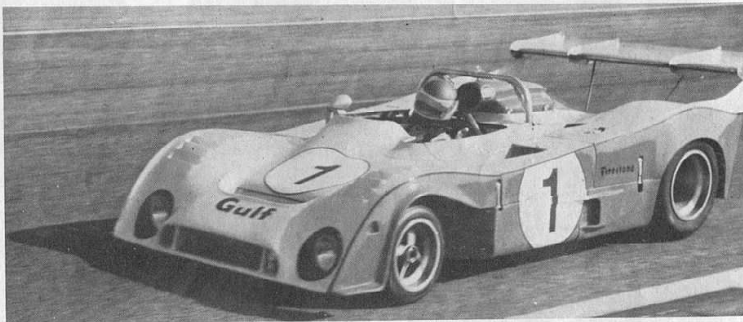
Derivata direttamente dalla Gulf-Mirage M6, la Gulf GR 7 è stata migliorata accuratamente, soprattutto nelle sospensioni posteriori e nel peso complessivo, ora calato di ben 65 chilogrammi
