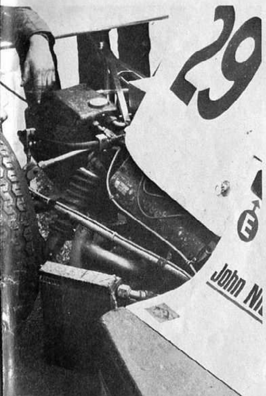
Ecco una bella veduta laterale della Lyncar. E' probabile che, dopo le prime prove, la vettura affidata a John Nicholson, subirà delle modifiche per affinarne la linea. A sinistra i radiatori laterali dell'olio sulla Lyncar sono esposti e creano turbolenze. Forse saranno inseriti
