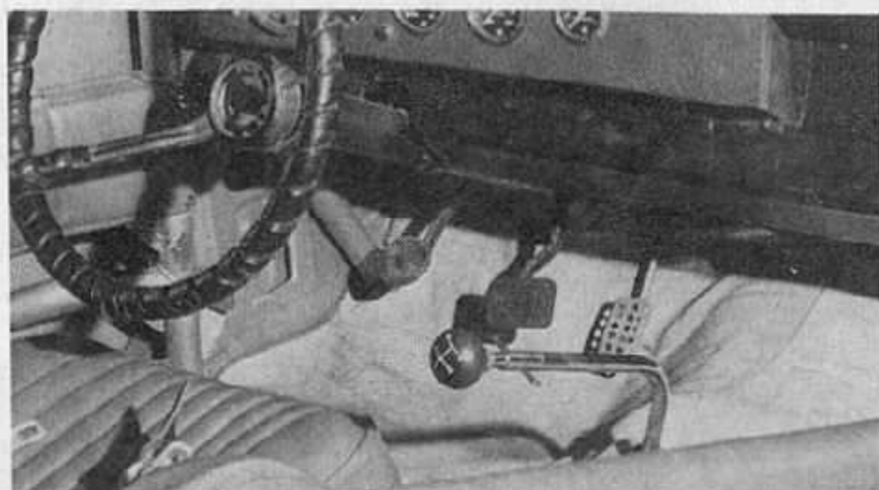
La sicurezza è la parola d'ordine nelle Stock Cars: vediamo il pavimento ricoperto da fogli d'amianto
