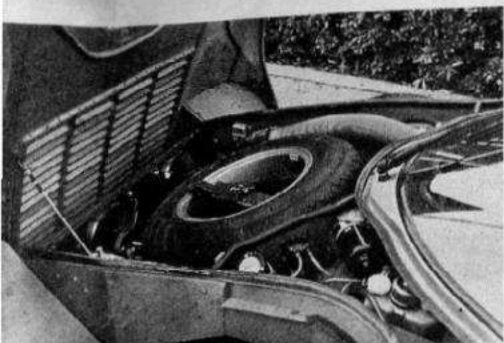
Davanti, radiatore, con i due ventilatori, e ruota di scorta
