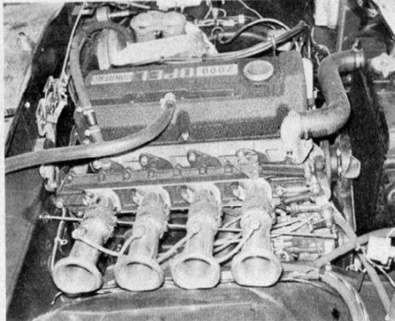
Virgilio Conrero (a sinistra) si sta intensamente preparando alla stagione che è al debutto. Sopra, il motore Opel Ascona che ha raggiunto i 226 CV. Sotto, l'interno di una Opel Ascona gruppo 2
