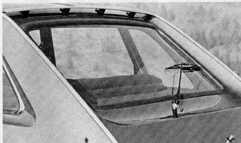
Un dettaglio significativo della Renault 16 TX, relativo alla parte posteriore: il piccolo alettone superiore, ed il tergi del lunotto
