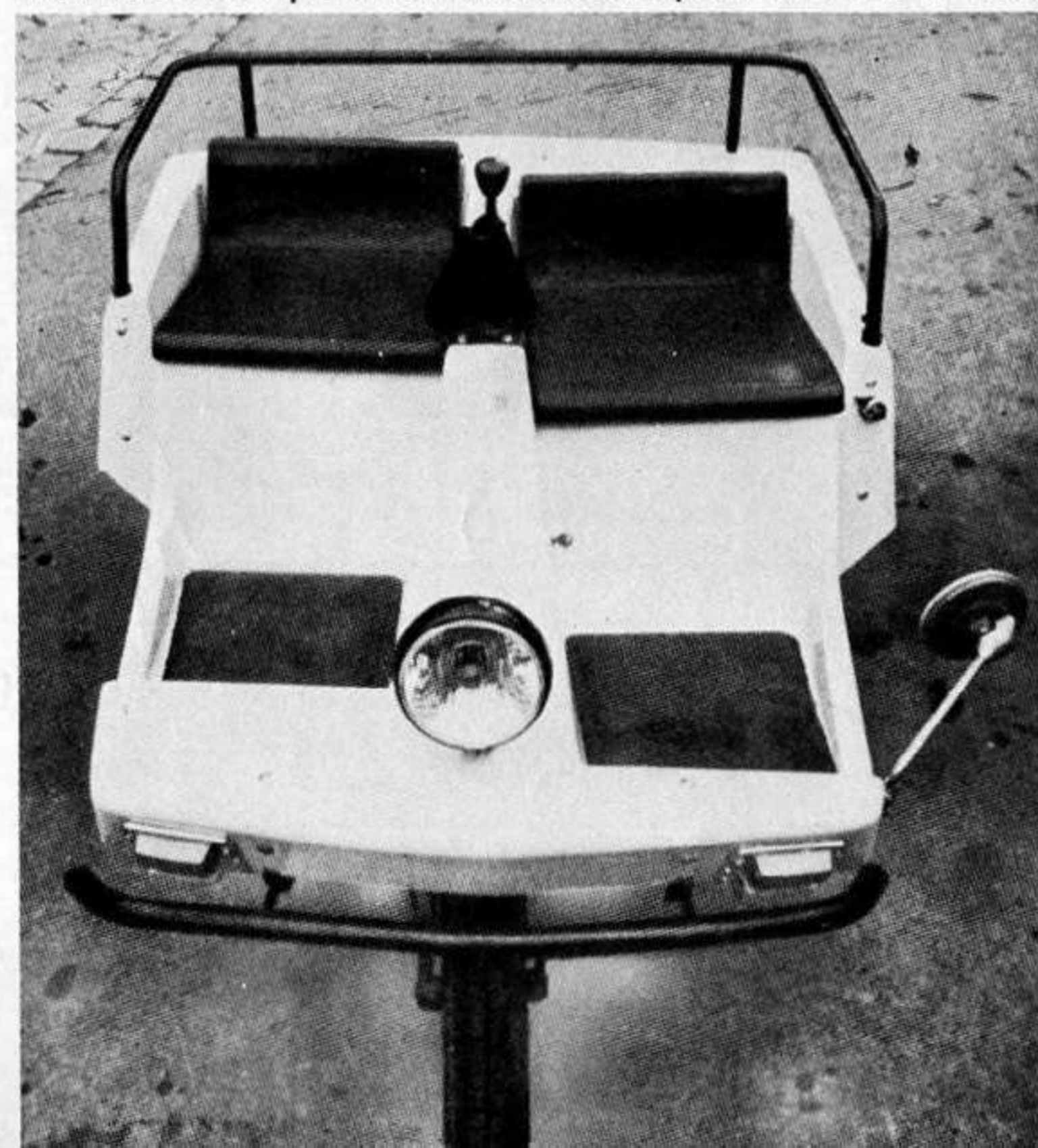
Sopra, la Comuta, minivettura sperimentale elettrica della Ford Motor Company. E' azionata da 4 batterie da 12 Volts. Sotto, un altro interessante esempio di vettura elettrica è questa tre ruote francese
