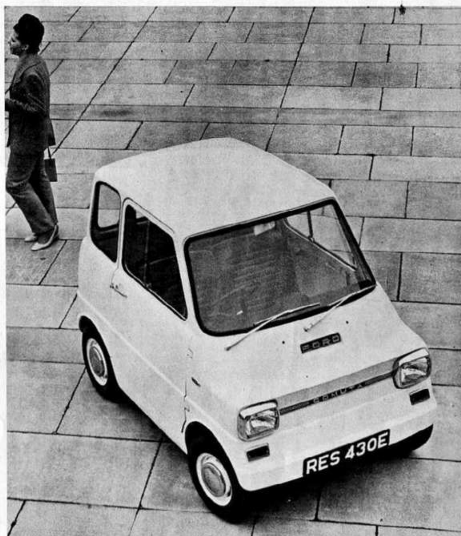
Sopra, la Comuta, minivettura sperimentale elettrica della Ford Motor Company. E' azionata da 4 batterie da 12 Volts. Sotto, un altro interessante esempio di vettura elettrica è questa tre ruote francese
